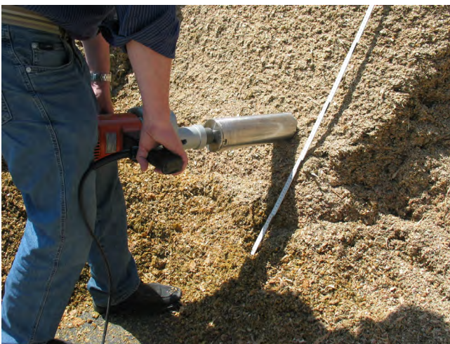
Abb. 3 + 4: Dichteborher im Einsatz (Quelle: LfL-ITE)
