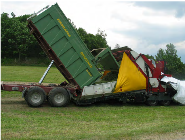
Abb. 9 + 10: Folientunnel (Silospeed ALKA)
