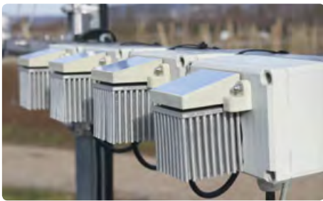
Die neuartigen Sensoren zur Erfassung der Blattnässe
